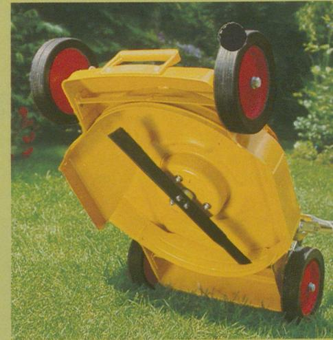
**Das besonders leise vibrationsfrei arbeitende Spezialmesser** ist aus einem Stück und bewirkt eine optimale Grasförderung. Es arbeitet in Verbindung mit dem Mähkanal im „Sog“-Verfahren. Niedergetretene Gräser werden beim Schneiden aufgerichtet und glatt abgeschnitten.
